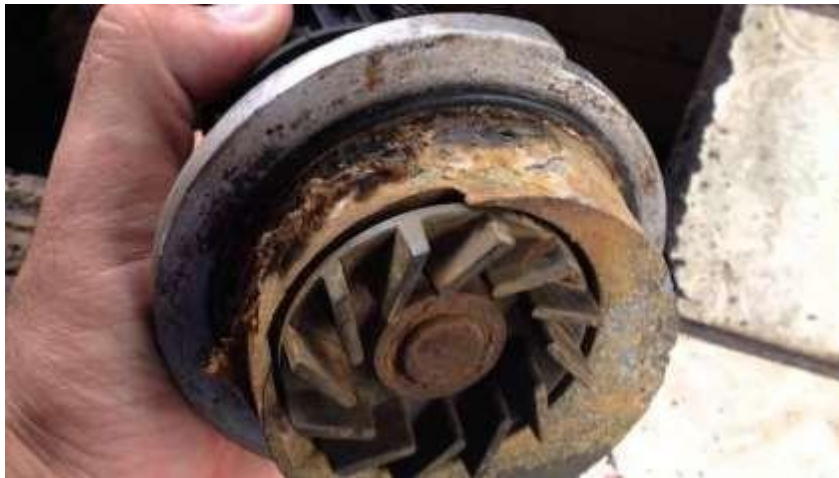
Figura 2 – Bomba danificada por funcionamento a seco.
