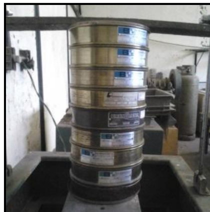
Figura 2.9 – Operação de peneiramento.
