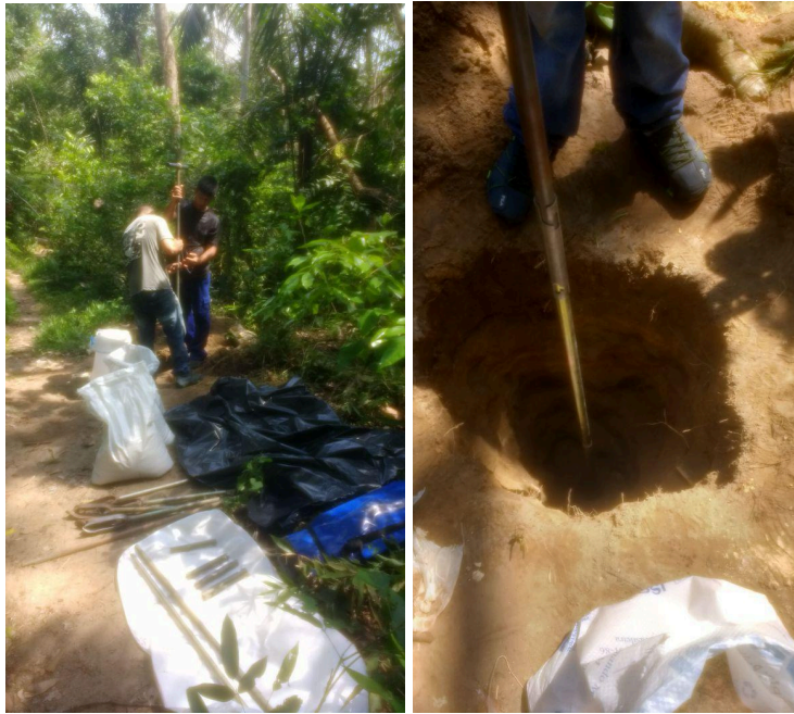
Figura 2.2 - Perfuração do solo com trado. Figura 2.3 – Furo para coleta.
