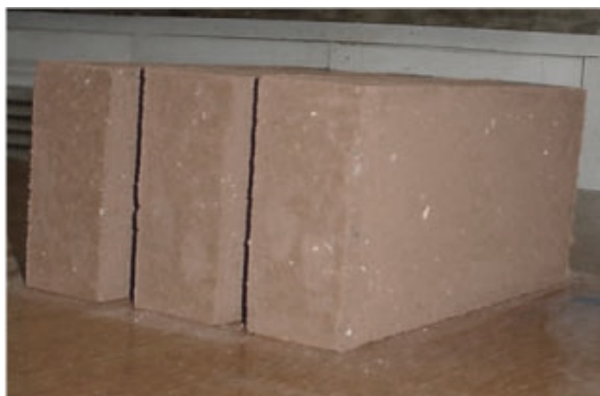
Figura 2.14 – Tijolos maciços produzidos com traço adotado.
