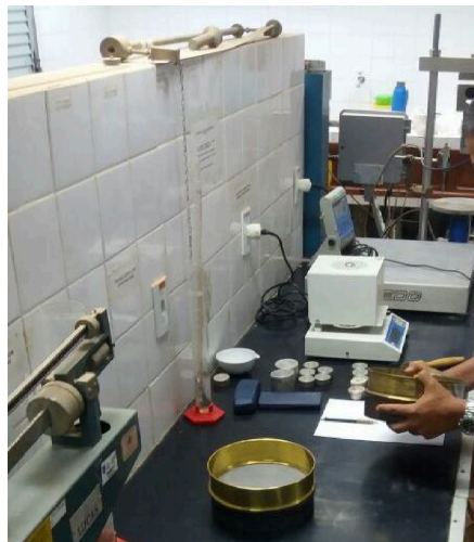
Figura 2.5 – Separação de peneiras para realização do ensaio.
