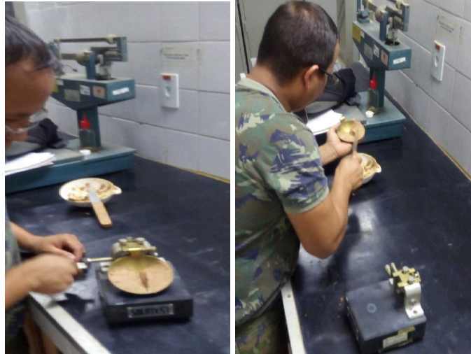
Figura 2.4 – Preparação e execução do ensaio de LL.
